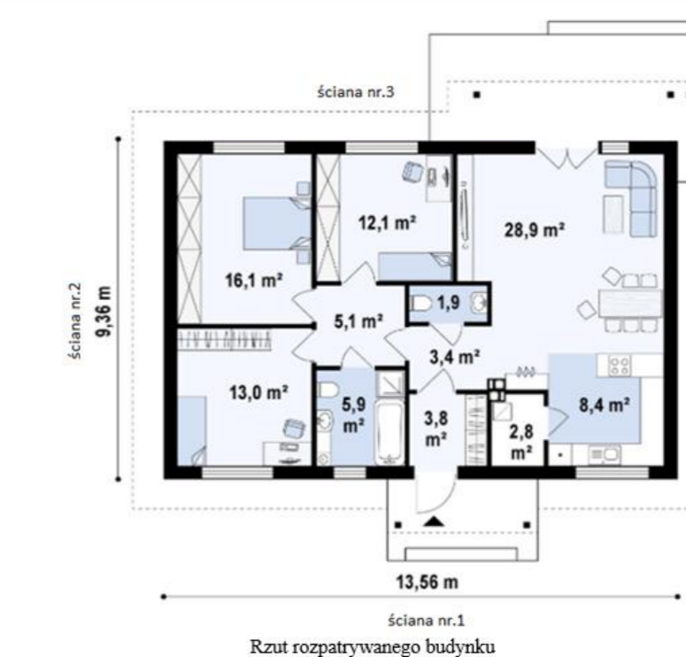
Rzut rozpatrywanego budynku
