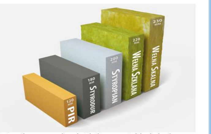
Porównanie wymaganej grubości danego materiału izolacyjnego przy zachowaniu tego samego oporu cieplnego
